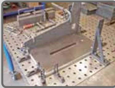
Einlegen der Bauteile auf einem
